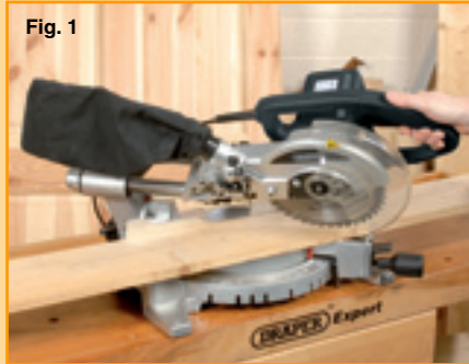
Fig. 1 Bevel cut at 45° mitre ±45°
