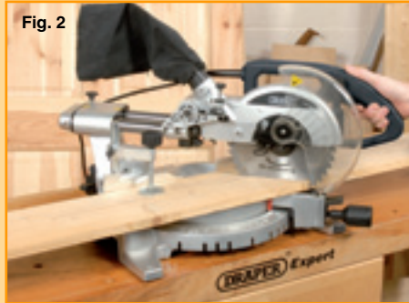
Fig. 2 Bevel at 45° mitre 0°
